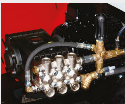
Vista generale interno: pompa, valvola di regolazione, filtro alimentazione, iniettore detergente, tubo by-pass.
