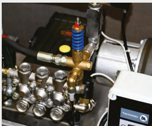
Dettaglio pompa: accoppiamento con giunto elastico, valvola di regolazione pressione.
