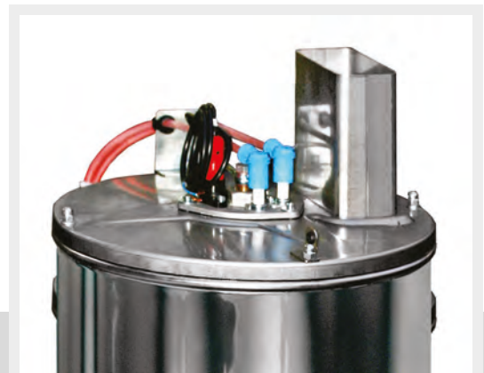
Testa di combustione tipo A-B-C-D: ugello gasolio, elettrodi di accensione, connettori alta tensione, tubo gasolio in acciaio ramato, controllo fiamma, camino fumi.
